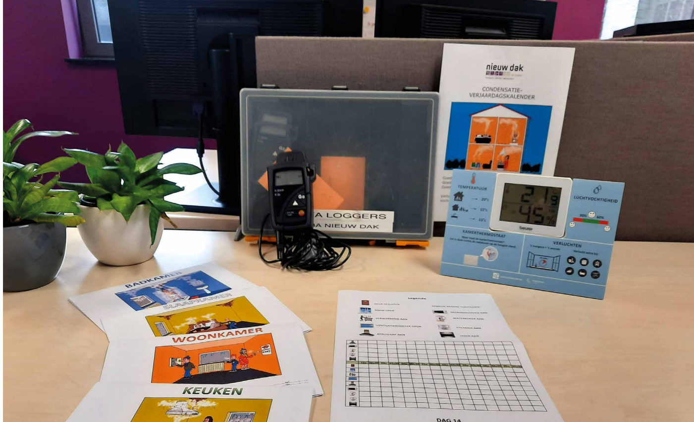
De woonmeter (blauwe toestel) spreekt klare taal, wat eventuele taalbarrières wegwerkt. Op het toestel staan vier vuistregels uitgelegd met eenvoudige pictogrammen. Zo kunnen ook anderstaligen ermee aan de slag.
